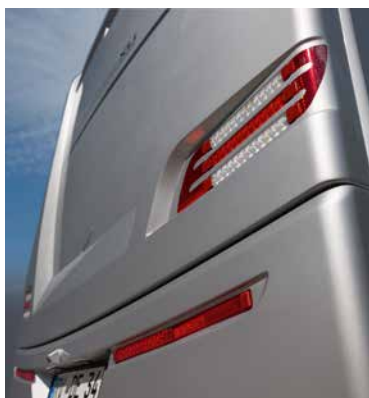
+ Reparationsvänligt: 2-delat bakparti av glasfiberförstärkt plast (GFK) (1)
