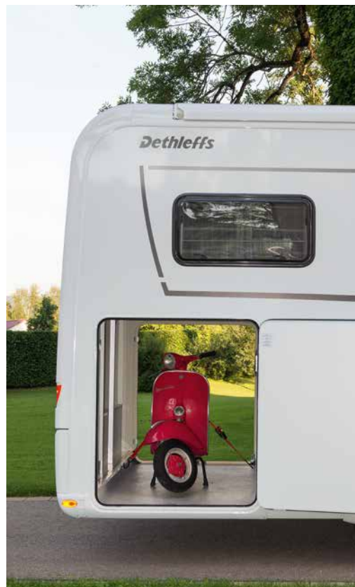
+ Stort, LED-upplyst bakre förvaringsutrymme (250 kg ytbelastning) (5)
