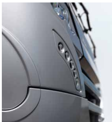
+ 2-delat frontparti av glasfiberförstärkt plast (GFK) med LED-varselljus (2)
