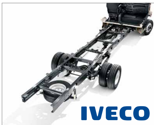
+ Robust Iveco Daily chassi med tandemaxel och upp till 7,2 t tillåtet totalvikt (tillval)
