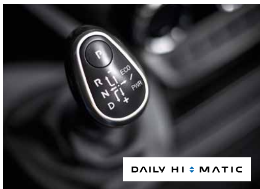
+ Automatväxellåda HI-MATIC med 8 växlar för högsta krav till körkomfort och lågt bränsleförbrukning vid optimal yttelse (tillval)
