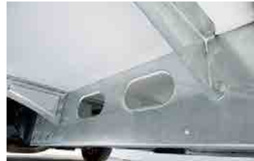
+ Dethleffs Lifetime-Plus Det träfria undergolvet är klätt med glasfiber på båda sidor
