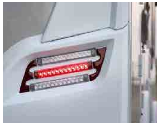
+ Enkel att reparera: Bakpartiet i flera delar med strömsparande LED-baklyktor
