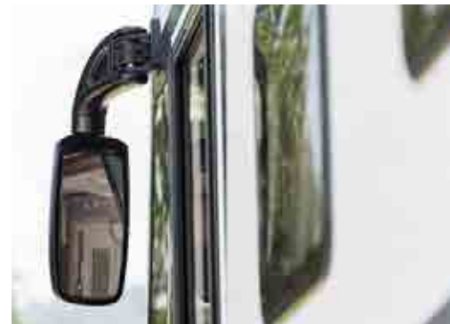
+ Bakspeglarna har monterats hängande och garanterar ostörd sikt. De kan justeras och värmas upp elektriskt.
