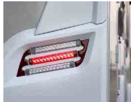
+ Enkel att reparera: Bakpartiet i flera delar med strömbesparande LED-baklyktor
