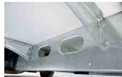
+ Dethleffs Lifetime-Plus: Det träfria undergolvet är klädd på båda sidor med GFK
