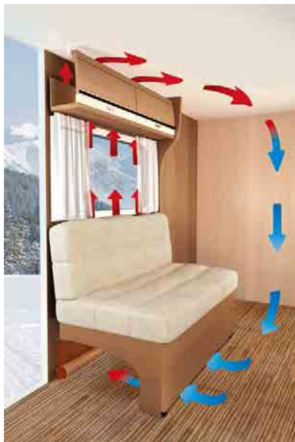
+ Behagligt inomhusklimat tack vare Air Plus bakre ventilation av överskåpen
