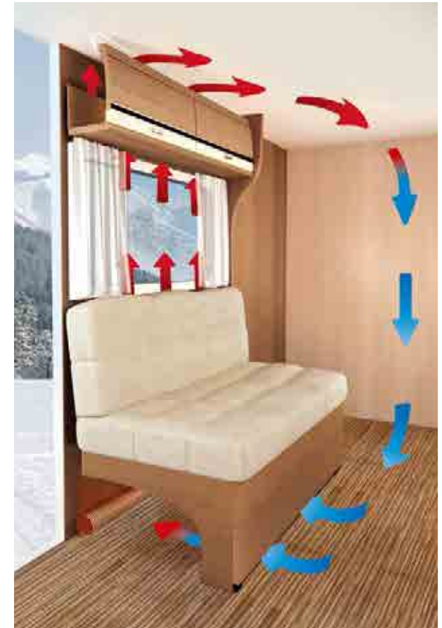
+ Bra rumsklimat: ventilationen i överskåpen "AirPlus" förhindrar att kondensvatten bildas i överskåpen.
