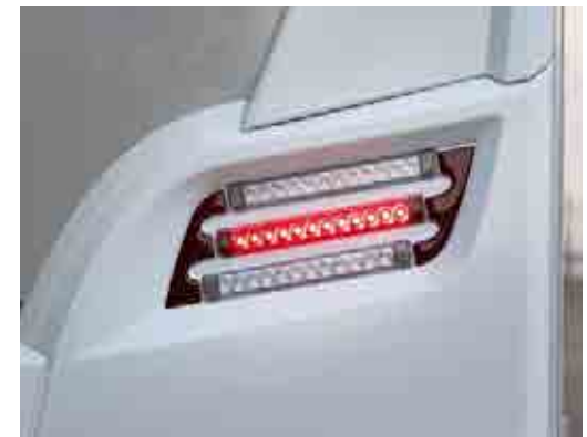
+ Enkel att reparera: Bakpartiet i flera delar med strömbesparande LED-baklyktor
