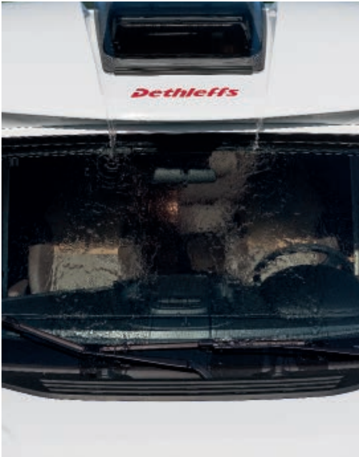
» Regnvattnet leds bort från taket i vattenkanaler som löper till bakpartiet och vindrutan
