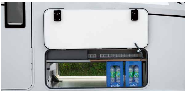
+ Förvaringsutrymme i dubbelgolvet (1).
