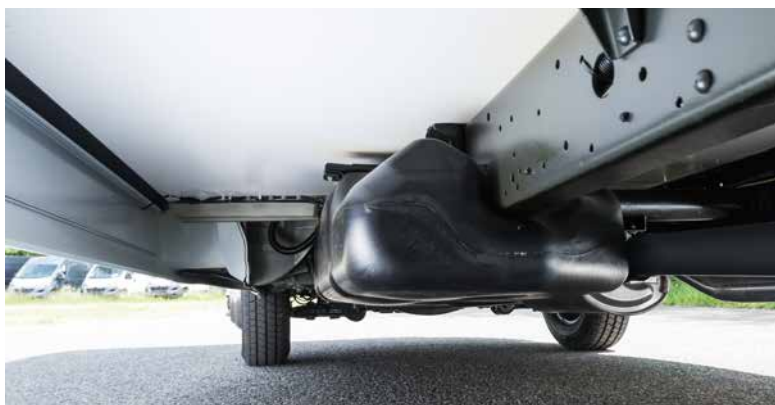
+ Undergolv klätt i glasfiberförstärkt plast.
